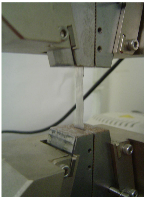
Figura 46: equipamento Instron com corpo de prova e focado no corpo de prova
