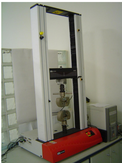
Figura 46: equipamento Instron com corpo de prova e focado no corpo de prova
